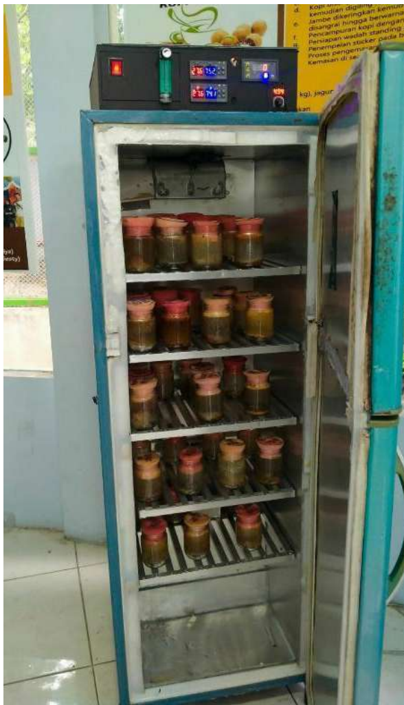
Gambar 2. Inkubator Lalat Buah di Laboratorium Kami
