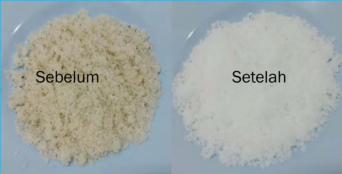
Gambar 3. Hasil garam sebelum dan setelah timer sprayer dan filter osmosis
