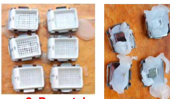
2. Pencetak Parafin blok yg lama boros bahan
