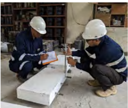
Pengukuran Selimut beton
