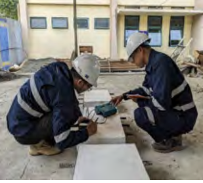
Pengujian dengan Profometer
