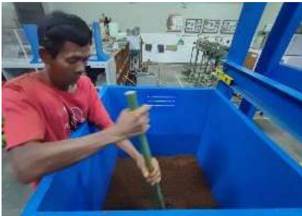
Gambar 11: Pemasakan sampel tanah di dalam bak
