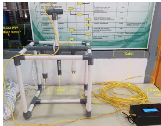
Gambar 5: Data logger suhu, salinitas, dan kekeruhan
