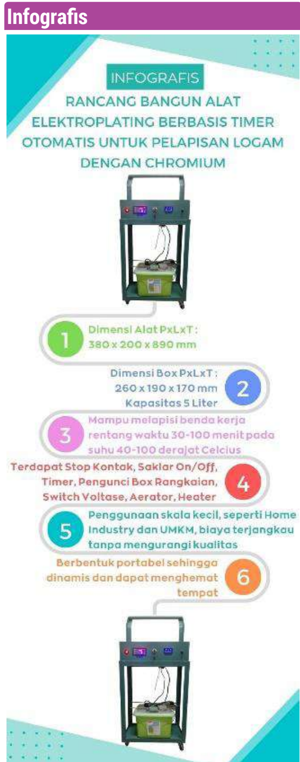
Gambar 1: Infografis Rangkuman Alat Elektroplating
