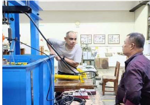
Gambar 14: Pengujian Pendahuluan/pra pembebanan tanah lapis atas, pembacaan menggunakan load cell , LVDT dan pencatatan menggunakan data logger setiap 1 detik
