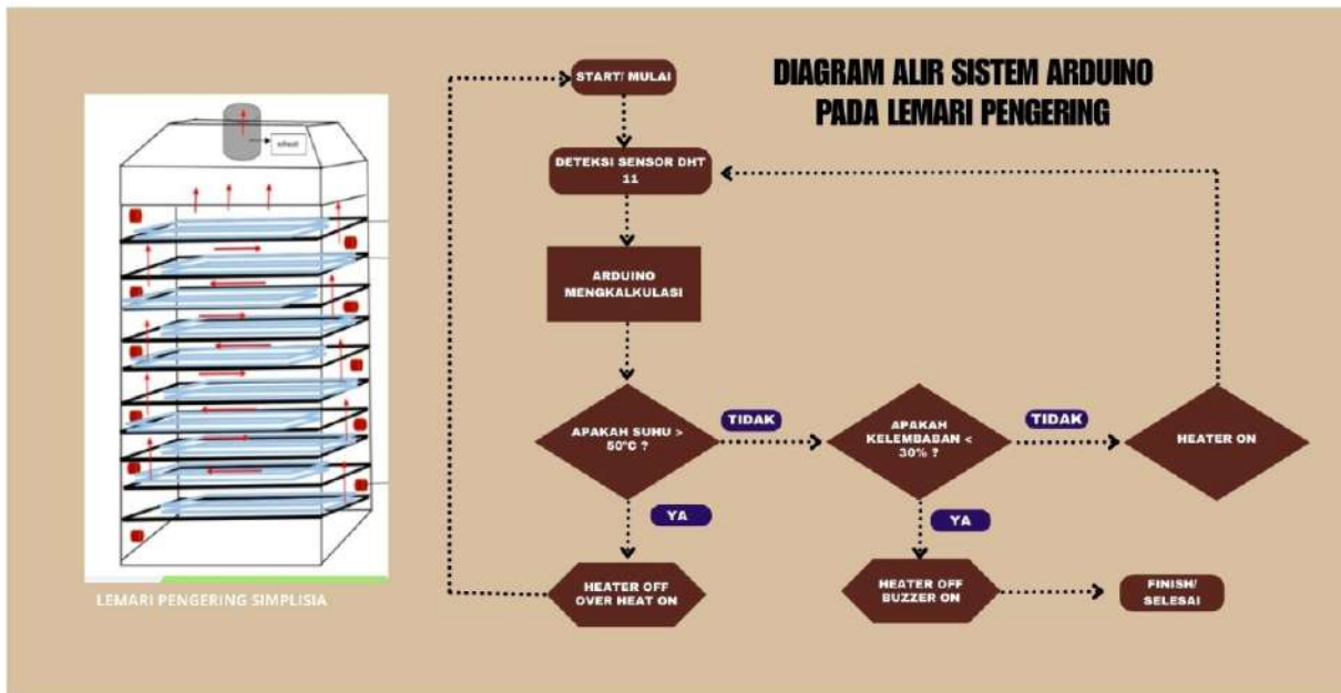
Gambar 1: Diagram alir sistem arduino pada lemari pengering
