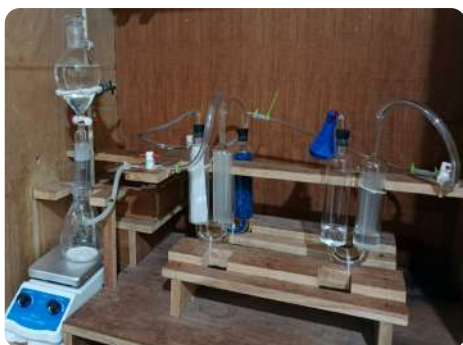
Gambar 2: Rangkaian alat absorpsi CO 2 termodifikasi
