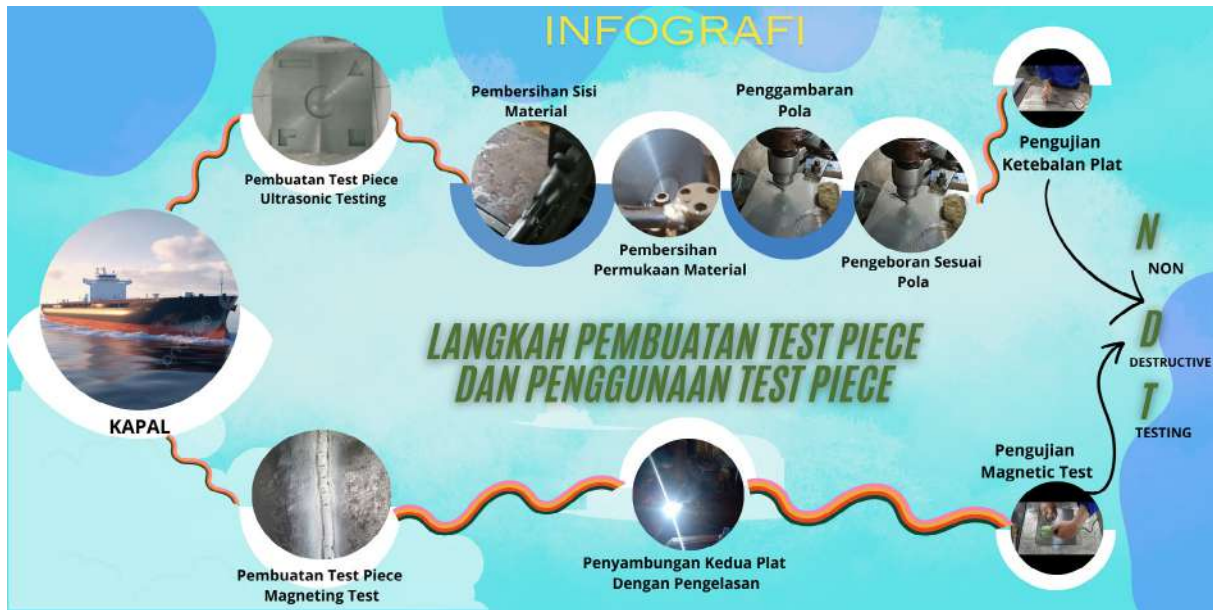
Gambar 3: Infografis Langkah Pembuatan dan Penggunaan Test Piece
