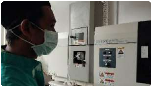
Gambar 4: Uji logam berat menggunakan AAS
