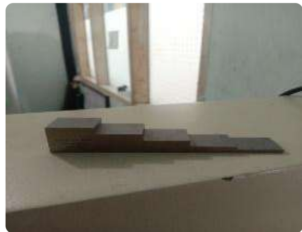
Gambar 1: Test Piece Ultrasonic Thickness Test sebelumnya
