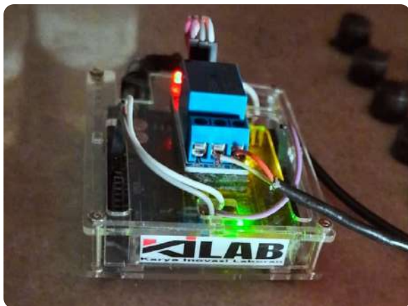
Gambar 9: Perangkat elektronik pembangkit detik bintang digital
